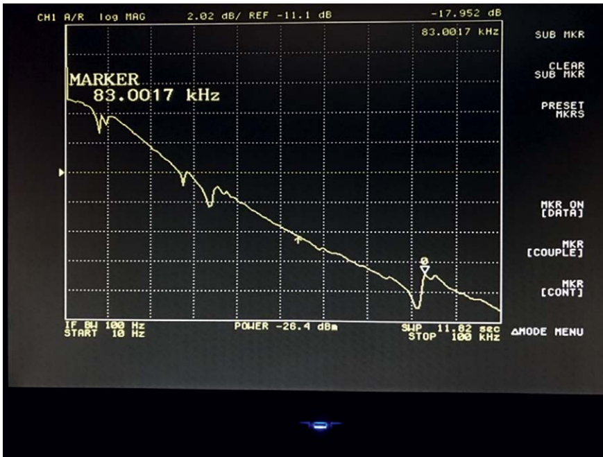
Bild 3: Mit einem Netzwerkanalysator ermittelter Frequenzgang eines Piezoaktors.
