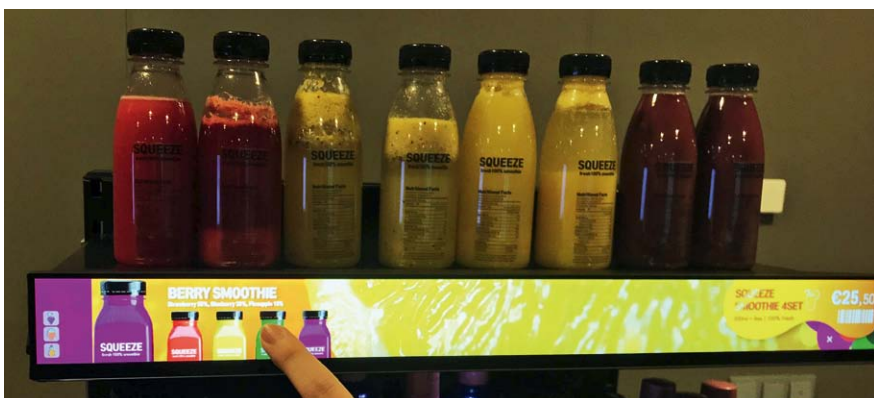
Bild 7: Electronic Shelf Label Display installiert in einem Supermarktregal.
