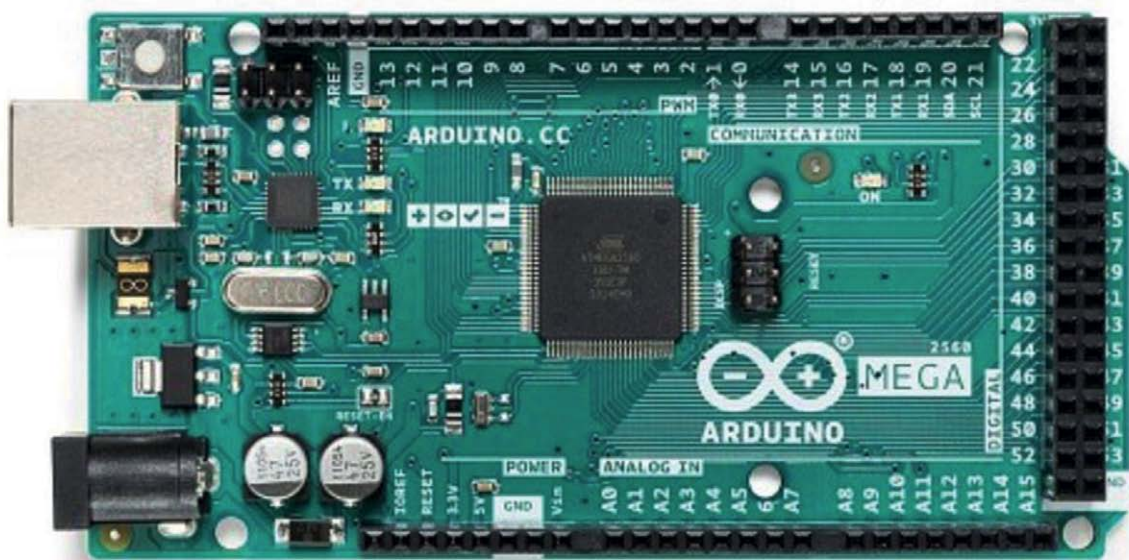
Bild 2: Das Board Arduino Mega 2560 Rev3 basiert auf dem 8-Bit-Mikrocontroller ATmega2560, der mit 16 MHz läuft. Aufgrund der Grundfläche seiner Stiftleisten kann er die gleichen Abschirmungen wie der Arduino Uno tragen, verfügt aber über zusätzliche Stiftleisten, die insgesamt 54 digitale E/A-Pins und 16 analoge Eingangspins zur Verfügung stellen.
