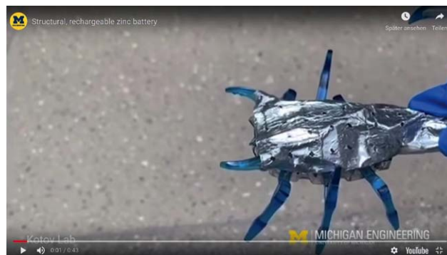
Bild 5: Die Außenhaut dieses Spielzeug-Roboters bildet die biomorphe Zink-Luft-Batterie, mit der dieser Skorpion mit Energie versorgt wird [5].
