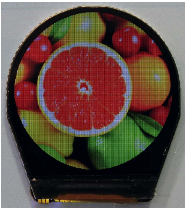
Bild 4: Kleinformatiges Display mit kreisförmiger Bildfläche für den Einsatz zum Beispiel in Smart Watches.
