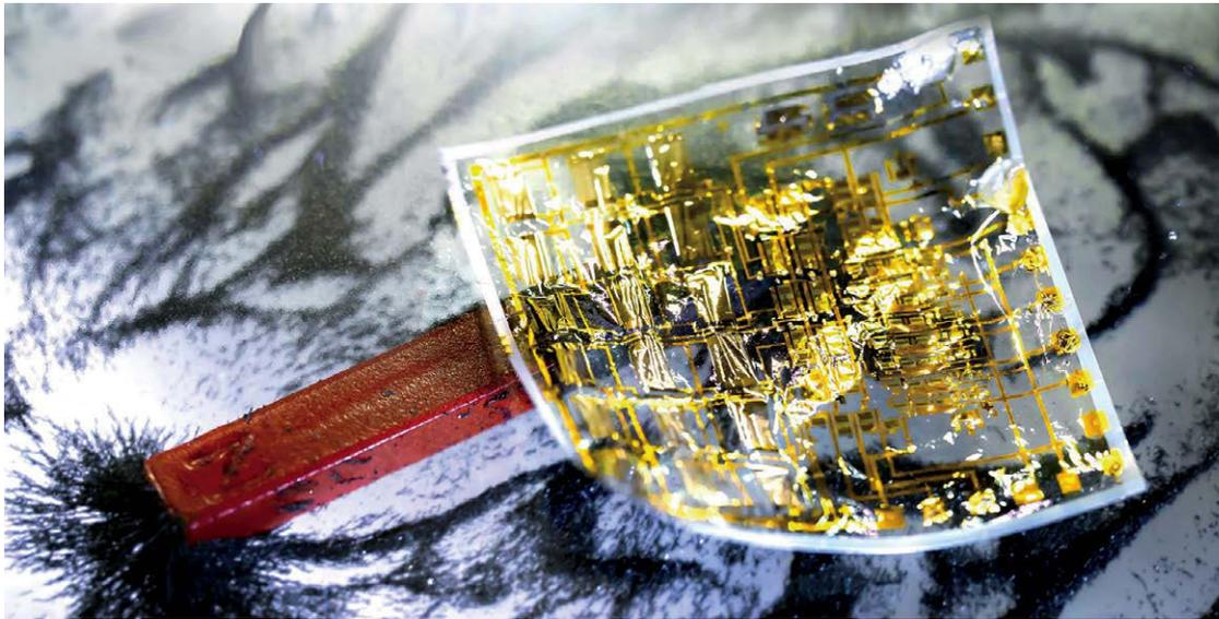
Auf dem Weg zur „elektronischen Haut“ sind Forscher aus Chemnitz, Osaka und dem Leibniz-Institut für Festkörper- und Werkstoffforschung in Dresden. Ihre in einer Plattform hochintegrierten elektronischen Komponenten wie Magnetsensoren, Bootstrap-Schieberegister und organische Signalverstärker basieren auf organischen Dünnschichttransistoren.
