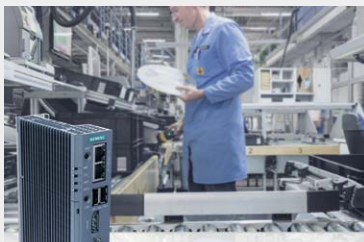
Typisches Anwendungsszenario des IoT-Gateways Simatic IOT2050: die präventive Wartung von Maschinen und die Kopplung der Produktion an die ERP-Ebene.
