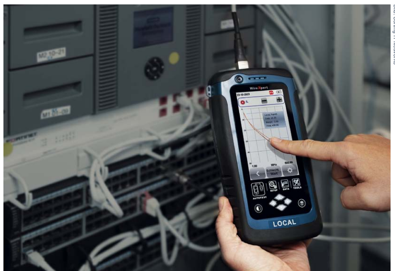
Die Messung der Einfügedämpfung bewertet die Signalabschwächung über den gesamten Weg.
