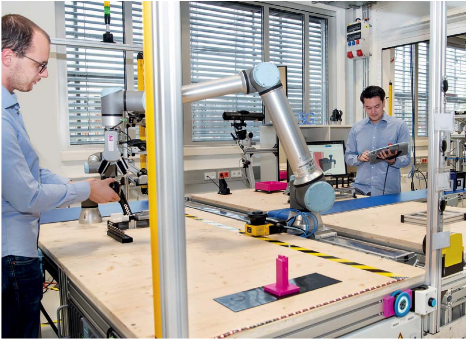
Die Robotics Hands-on Area ist eine modular aufgebaute Test- und Verifikationsplattform, in der unterschiedlichste industrielle Anwendungsfälle nachgestellt sowie deren physische Sicherheit nachgewiesen werden kann.
