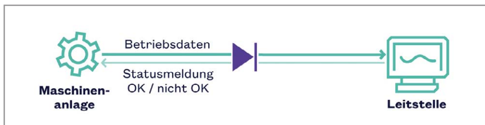
Für sensible Anlagenbereichen eignen sich Datendiode. Durch ihre One-Way-Architektur erlauben sie eine risikolose Ausleitung von Daten.
