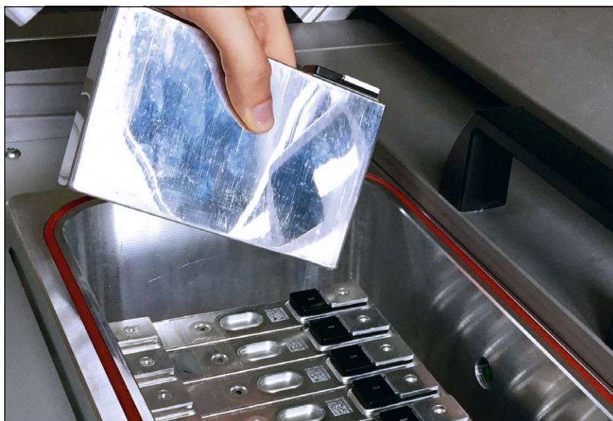
Bild 4. Batch-Testing prismatischer Batteriezellen in einer größeren Vakuumkammer. (Quelle: Inficon)
