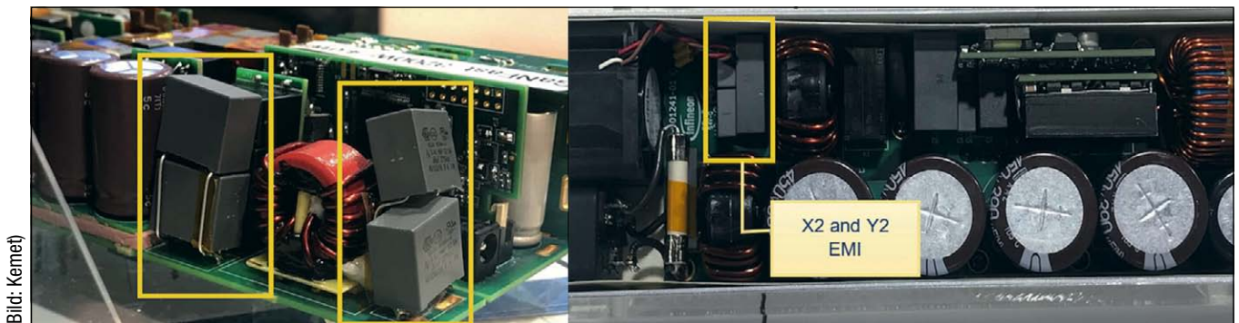
Bild 3. Extreme Designs für X2-Kondensatoren mit begrenzter Leiterplattenfläche für Stromversorgungen mit hoher Energiedichte und Wide-Bandgap-Halbleitern.
