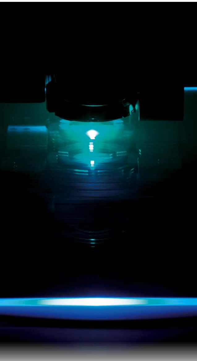
Hier ist der Belichtungskopf der Lithoscale zu sehen, der gerade über das zu belichtende Substrat fährt. In diesem Fall handelt es sich um ein rechteckiges Panel, dessen vordere Kante im unteren Teil des Bildes aufscheint. Die Wellenlänge des Lichts ist einstellbar, sodass alle Fotoresists verwendet werden können.
