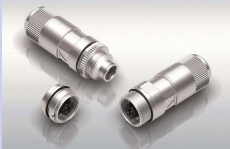
Zur Serie 415 von binder gehören neben Kabelsteckverbindern und -buchsen auch Einbaubuchsen, welche von vorne verschraubbar sind. Im gesteckten Zustand erreichen sie die Schutzart IP67. Die Steckverbinder aus der Serie 415 sind mit acht vergoldeten Kontakten bestückt, die bei 50 V Wechsel- oder 60 V Gleichspannung bis 0,5 A strombelastbar sind. (cp)
