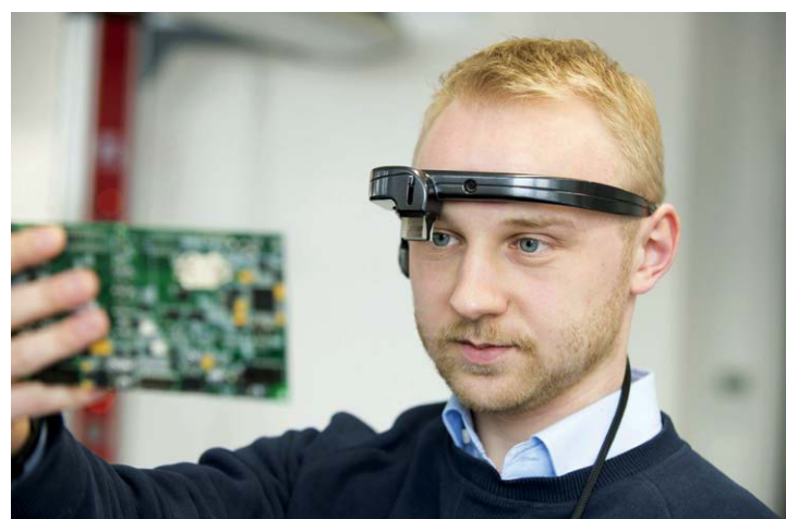
Der digitale Montageassistent von Kimoknow ist eine Augmented-Reality-Brille.
