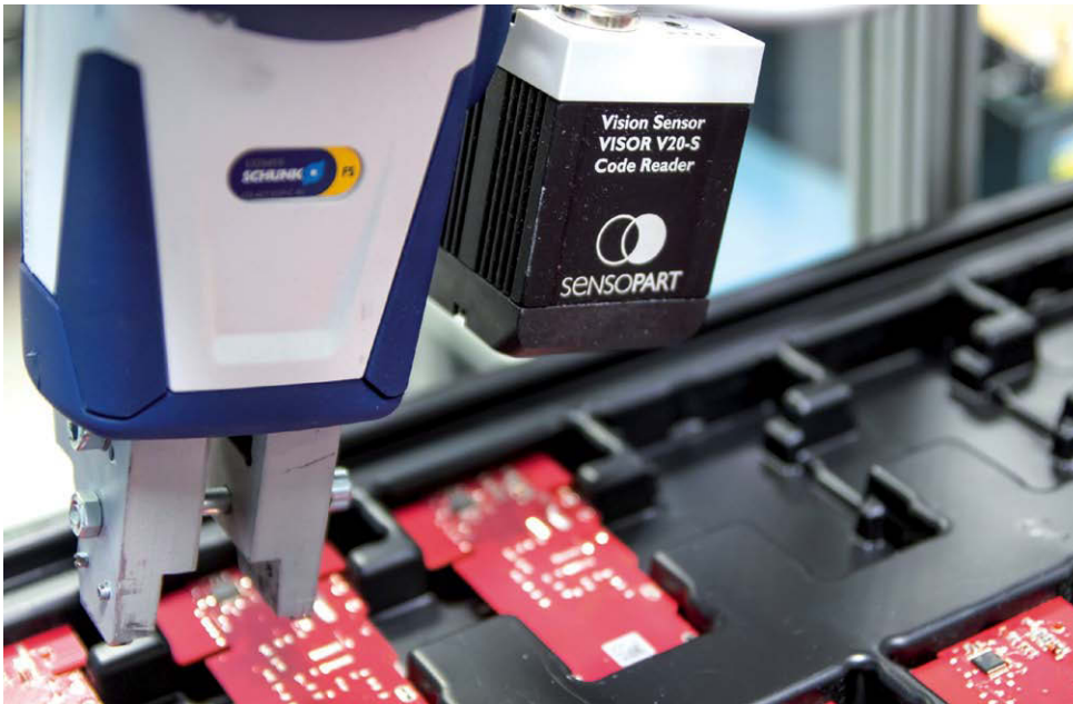
Um Gegenstände wie eine Leiterkarte zu bewegen, ist der Cobot mit einem 2-Finger-Greifer ausgerüstet.
