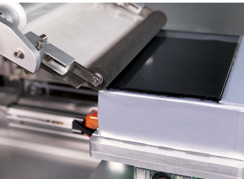
ESD-Schutzfolien senken die Wahrscheinlichkeit, dass es zu einem elektrischen Überschlag kommt, wenn beispielsweise die Schutzfolie von einem Display gelöst wird.
