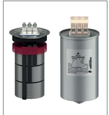
Bild 4. Kupferbänder mit geringem Widerstand, die eine gute thermische Anbindung zum Kondensatorbecher haben, ermöglichen eine bessere Entwärmung, was die Lebensdauer des Kondensators steigert.
