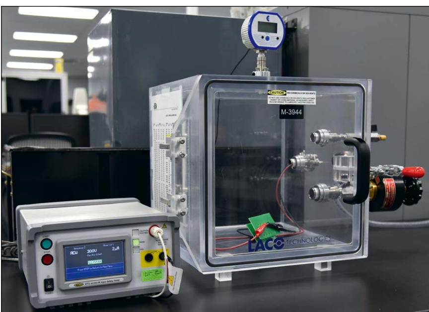
Bild 3. Die Spannungsprüfung (Dielectric Withstanding Voltage Test, DWV) ist eine in der Elektronik übliche Prüfung, die in der DWV-Höhenkammer stattfindet.
