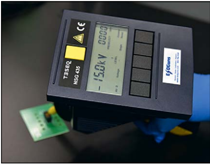
Bild 2. ESD-Test mit einer Prüfspannung von 15 kV.
