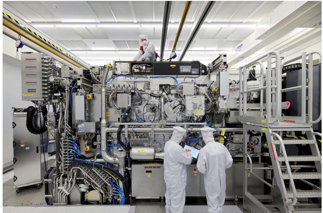
Blick in das EUV-Lithografiesystem vom Typ NXE:3400B von ASML, mit dessen Hilfe die neuesten Chipgenerationen gefertigt werden
