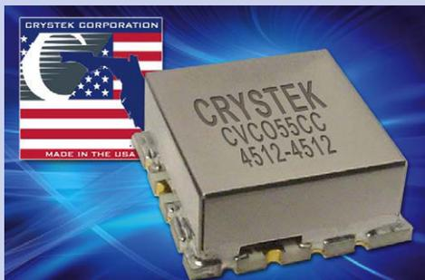
Der neue Voltage Controlled Oscillator (VCO) vom Typ CVCO55CC-4512-4512 des amerikanischen Herstellers **Crystek** arbeitet bei einer Frequenz von 4512 MHz mit einem Steuerungsbereich zwischen 0,3 V und 4,7 V. Der Oszillator erreicht ein Phasenrauschen von  $-105$  dBc/Hz bei 10 kHz Offset. Die Ausgangsleistung liegt bei typisch +4 dBm. Untergebracht im 0,5 Zoll x 0,5 Zoll-SMD-Gehäuse arbeitet er an einer Spannung von 5 V und nimmt
